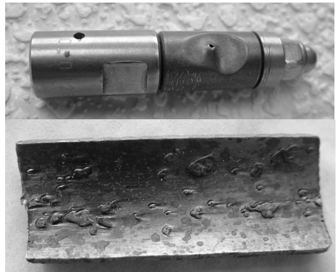
Рис. 1. Эрозионный износ рабочего сопла HAMMELMANN и трубок конденсатора после очистки их от накипи.
