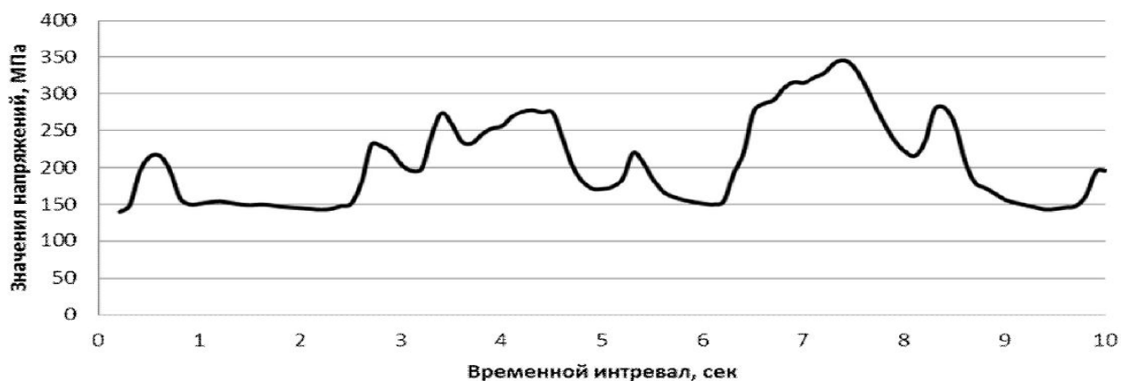
Рисунок 6. Временной интервал для расчета долговечности теплообменного оборудования РУ (расчетная долговечность 88800 часов, то есть более 10 лет) [9]
