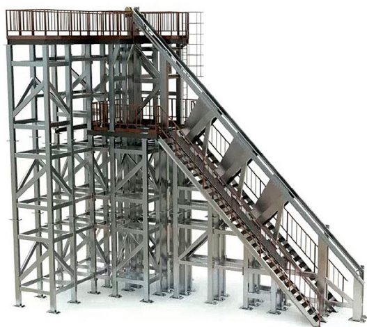
Рис 5. Випробувальна платформа для нахилого транспортера відпрацьованих збірок демонстраційного реактора
