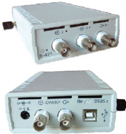
Рис. 3. Вимірювач інтервалів часу В-471. Вигляд з боку передньої і задньої панелей
