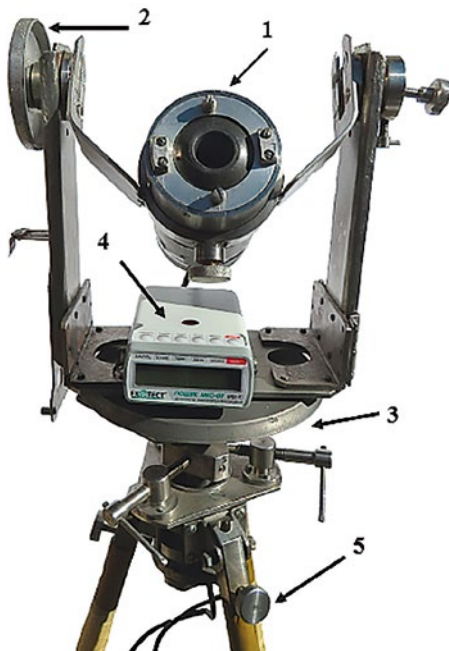
Рис. 1. Радіометр-дозиметр МКС-07 «Пошук» із виносним колімованим детектором: 1 — свинцевий корпус коліматора з детектором гамма-випромінювання БДБГ-10; 2 — лімб для встановлення коліматора з детектором у вертикальній площині; 3 — лімб для встановлення коліматора з детектором у горизонтальній площині; 4 — радіометр-дозиметр МКС-07 «Пошук»; 5 — тринога
