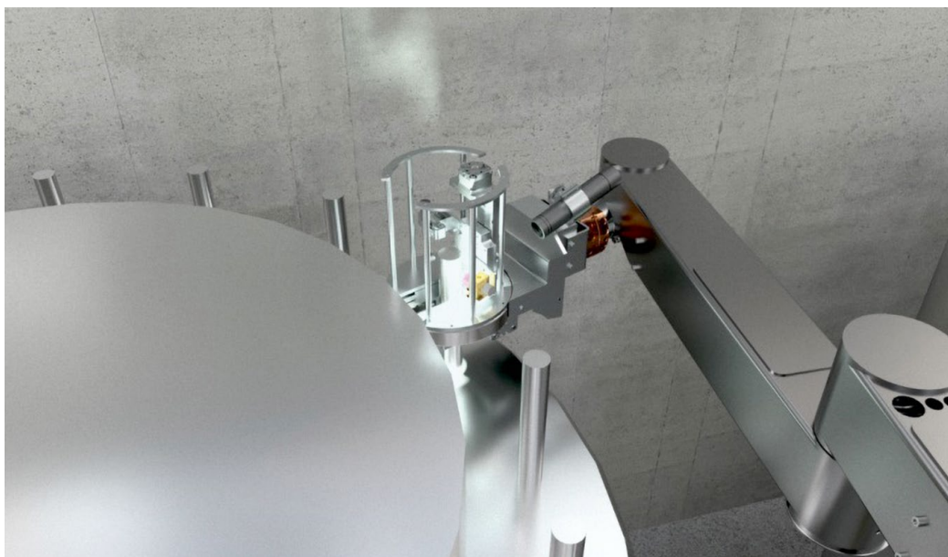
Рис. 8. Маніпулятор для встановлення модулів на трубу резервуара
