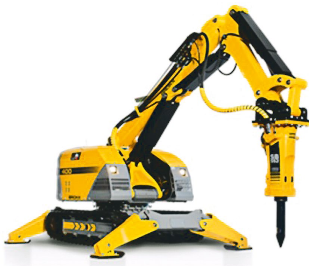
Рис. 4. Загальний вигляд ДКМ на власному ходу із пристроєм для швидкого роз'єднання і дистанційної заміни навісного обладнання
