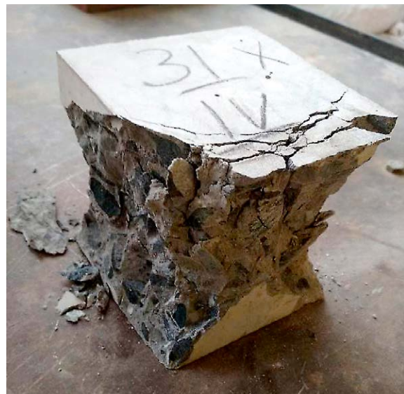
Рис. 8. Випробування радіаційно-захисного бетону на міцність
