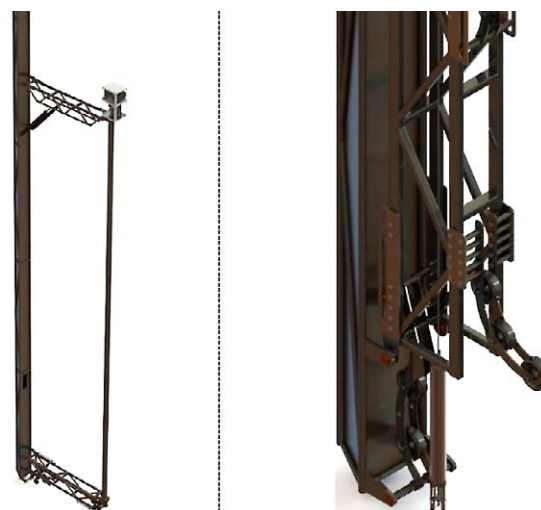
Рис. 6. Тривимірна модель пристрою для вилучення гільз реактора
