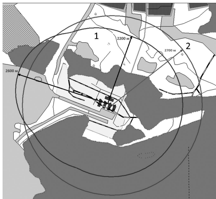
Рис. 2. Межа СЗ3 ХАЕС (1), визначена в результаті проведених розрахунків згідно з вимогами, та межа існуючої СЗ3 радіусом 2700 м (2)
