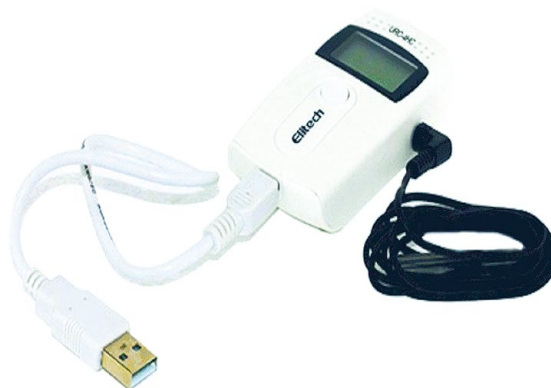
Рис. 1. Зовнішній вигляд метеостанції типу PCE FWS (а) та логера типу RC-4HC (б)
